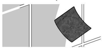
Entfernen Sie groben Schmutz wie Kalk, Zementschleier etc. mit beiliegendem Schleifvlies und geeignetem Reiniger.
