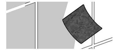
Entfernen Sie groben Schmutz wie Kalk, Zementschleier etc. mit beliebigem Schleifvlies und geeignetem Reiniger.
