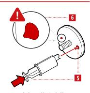
Klebstoff einfüllen Insert glue
